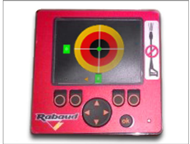
Inclinómetro con indicador visual en la cabina
