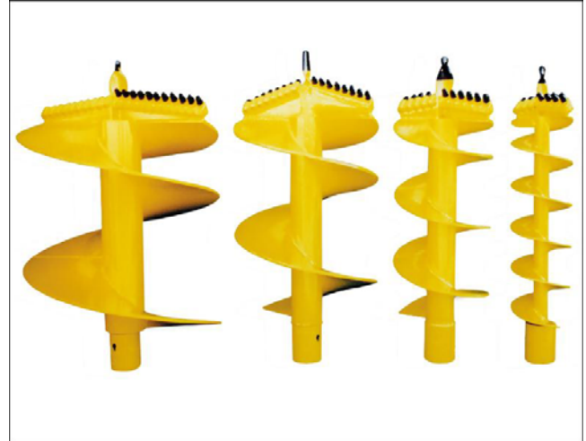
Vrilles à dents au carbure de tungstène et avec spires renforcées - Ø 400 à 1500 mm
